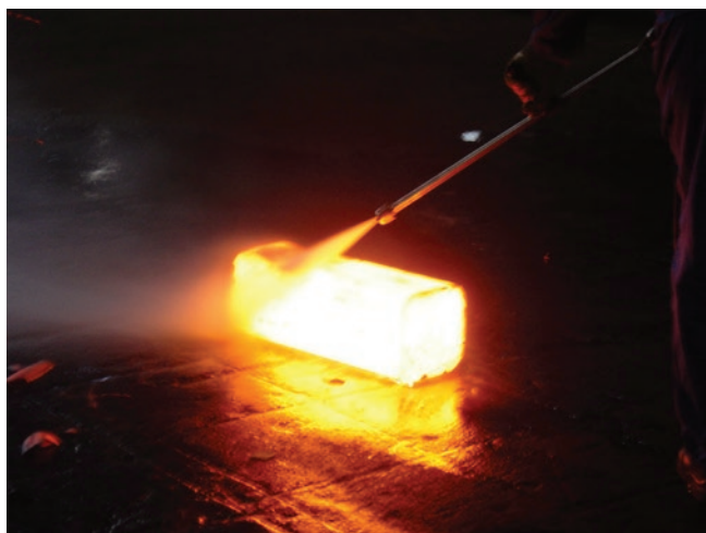
» Slika 4: Uporaba visokotlačne črpalke Uraca za dovajanje vode na šobo za odškajanje
