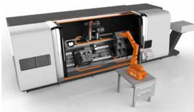
Slika 1 : Stroškovno učinkovito opremljen CNC-stroj z linearnimi vodili za samodejno odpiranje vrat, e-verigami za zaščito stroja in kablov ter robolinkom
